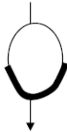
plan d'eau en travers du cours d'eau
